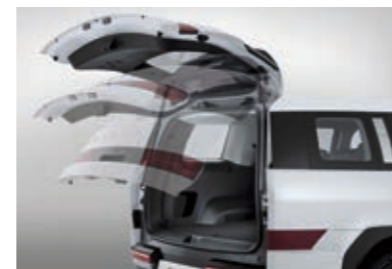
Електропривід дверей багажного відділення (з можливістю налаштувати висоту відкриття)
